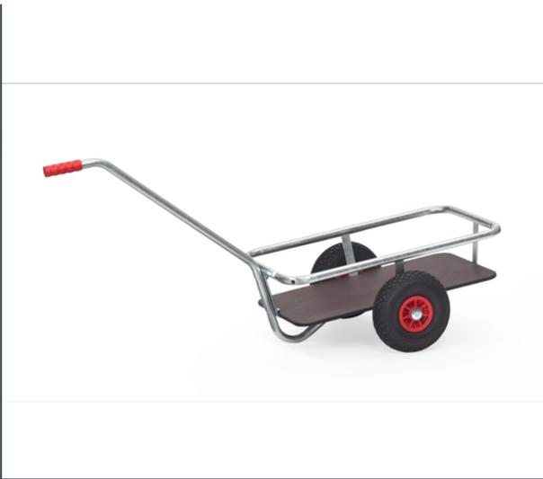
Leichter und sehr handlicher Handwagen. Aus Stahlrohr geschweißt, feuerverzinkt. Für die Verwendung im Außenbereich geeignet. Deichsel anschraubbar. Ladefläche aus wasserfestem Sperrholz. Räder mit Luftbereifung. Naben mit Rollenlager. Zerlegte Anlieferung, leichte Selbstmontage.
